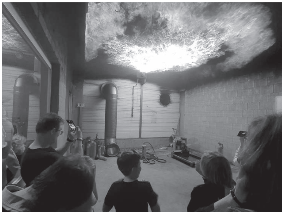
Mit einem sogenannten „Flash-Over“ wurde in Augsburg demonstriert, wie gefährlich sich ein Zimmerbrand entwickeln kann.
